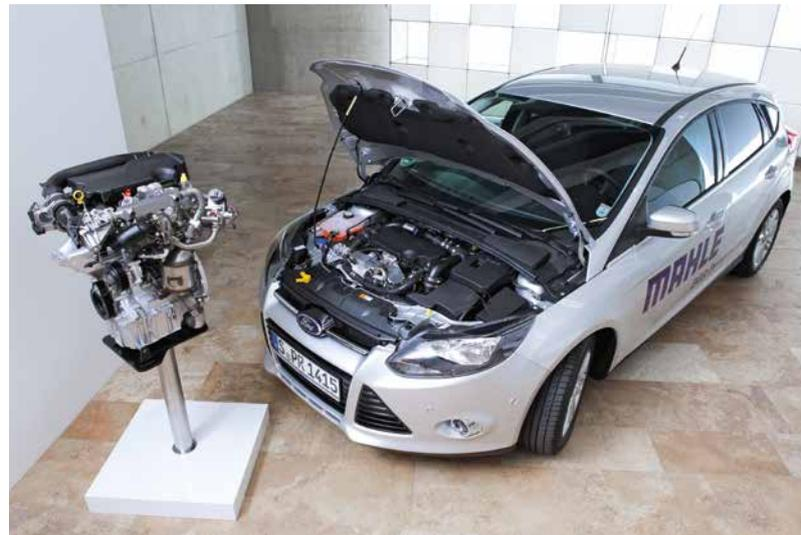
Das MAHLE AGR-Versuchsfahrzeug mit Großserien-Ottomotor und applizierter Hoch- und Niederdruck-AGR
