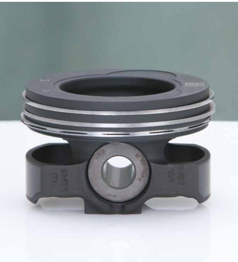
*Inklusive Kolbenringe und Kolbenbolzen wird der MAHLE MONOTHERM®-Stahlkolben erstmals für eine Pkw-Großserienanwendung geliefert.*
