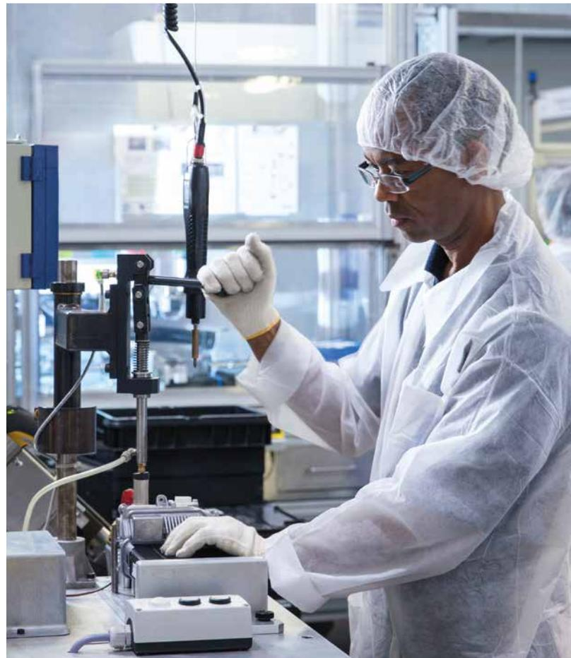
*Montage eines Reglers auf einem PTC-Heizer mit integrierter Dichtheitsprüfung*
